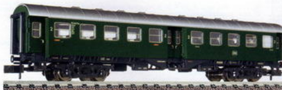
Mit Schwanenhalsdrehgestellen · With "swan-neck" bogies · Avec bogies «col de cygne»
